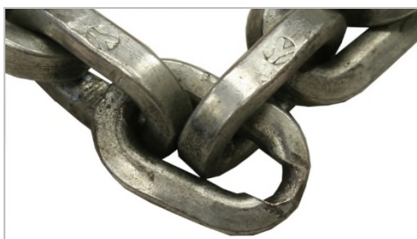
Duży stopień zużycia ogniwa łańcucha.
